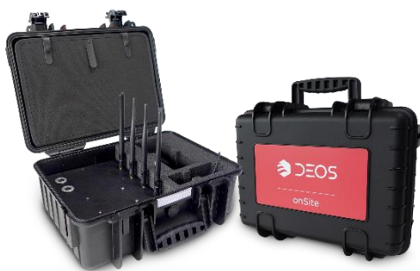
Abbildung 2: Die DEOS onSite-Box für den schnellen 1:1 Test im Gebäude
