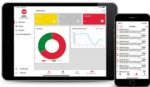
Alarmmanagement mit OPEN GATE: mit der DEOS Secure AlarmApp erfolgt die Alarmierung per Push-Nachrichten direkt auf dem Handy der Servicetechniker für die mobile Überwachung von HLK-Anlagen
