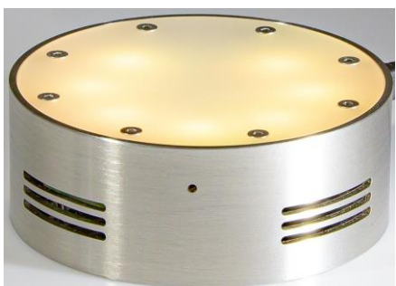
Abb. 4: Gerät mit gelber LED-Farbe nach erfolgreicher Kalibrierung / im Betrieb (der CO 2 -Gehalt in der Luft nähert sich dem Grenzwert)
