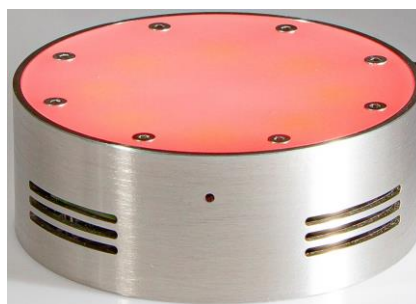
Abb. 5: Gerät mit roter LED-Farbe nach fehlgeschlagener Kalibrierung / im Betrieb (der CO 2 -Gehalt in der Luft hat den Grenzwert erreicht)
