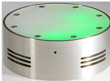
Abb. 3: Gerät mit grüner LED-Farbe nach erfolgreicher Kalibrierung / im Betrieb (der CO 2 -Gehalt in der Luft ist in Ordnung)
